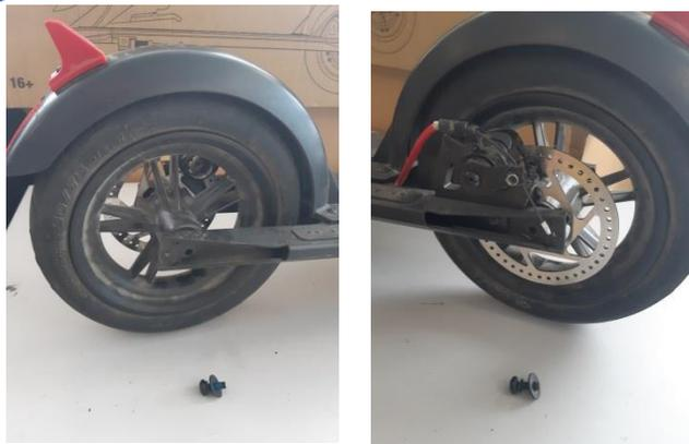
Retirer les vis allen (taille 5) de part et d'autre de la fourche qui maintiennent la roue arrière.
