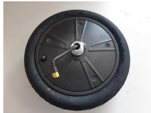
Lors du remontage, répétez l'étape 1 en marche arrière en mettant une pointe de frein-filet sur les pas de vis. si vous disposez d'une clé dynamométrique, les vis sont à serrer avec un couple de serrage de 45-50 Nm (pour la roue avant) et 15-18 Nm (pour la roue arrière)
