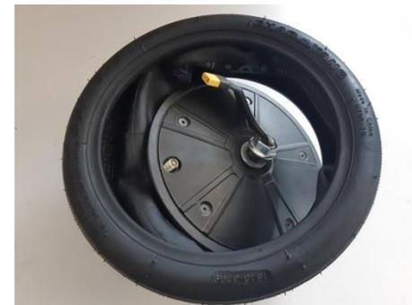
Rentrer d'abord la valve en laissant la chambre à air à l'intérieur du pneu, puis commencer par insérer le pneu derrière la valve.
